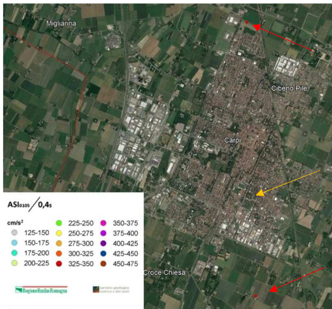
Fig. 7 – Griglia dei punti INGV di ASI_{UHS}/\Delta T per la zona di Carpi.
