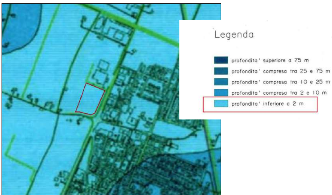
Figura 38 Carta della profondità media dei livelli freatici (perimetrata in rosso l'area di progetto)
