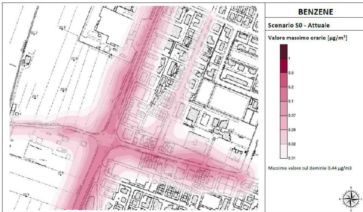
Mappa di isoconcentrazione del valore massimo orario per BENZENE - TRAFFICO INDOTTO SCENARIO S0 ( \mu\text{g}/\text{m}^3 )
