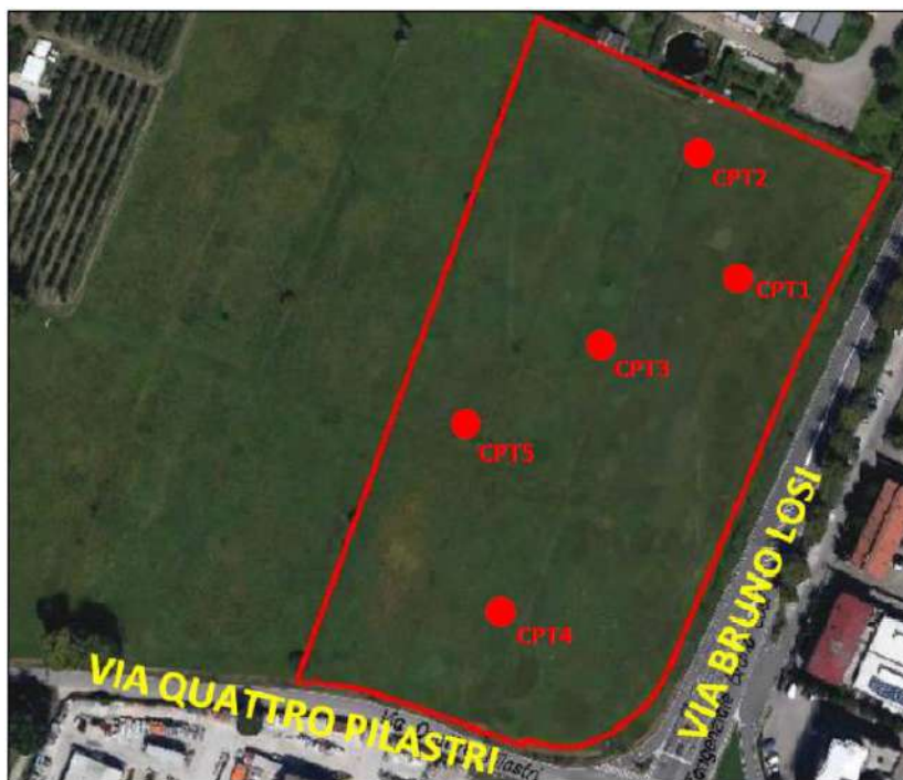
Figura 9 Ubicazione prove penetrometriche CPT
