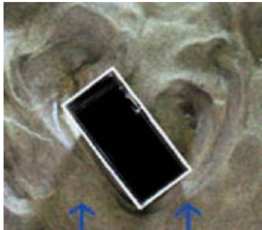
Figura 22: Esperimento di laboratorio, Dipartimento di Idraulica, Università di Pavia. Vista dall'alto di uno ostacolo rettangolare posto su letto sabbioso in seguito a simulazione.
