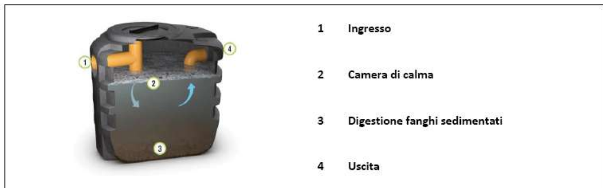
FIG. 3.15- TIPOLOGIA VASCA SETTICA IN POLIETILENE CORRUGATO
