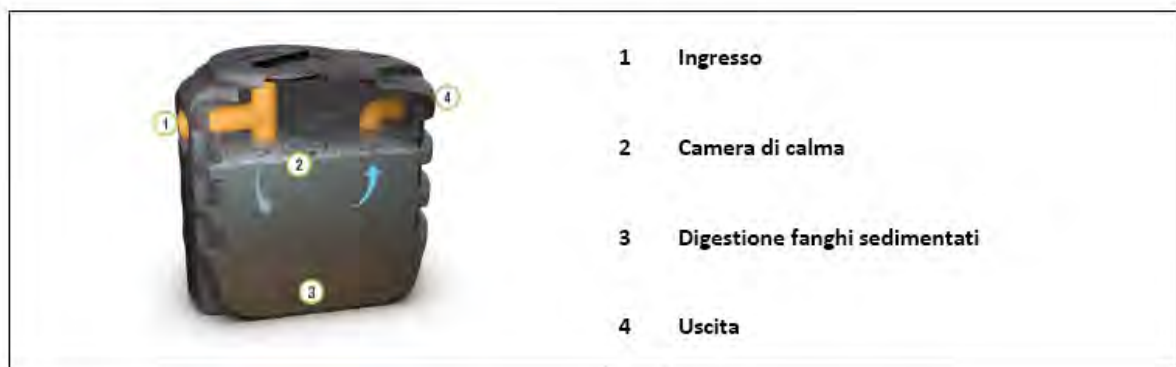
FIG. 3.15- TIPOLOGIA VASCA SETTICA IN POLIETILENE CORRUGATO
