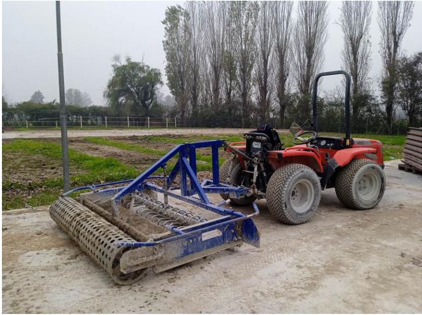
Figura 8: trattore per manutenzione pista
