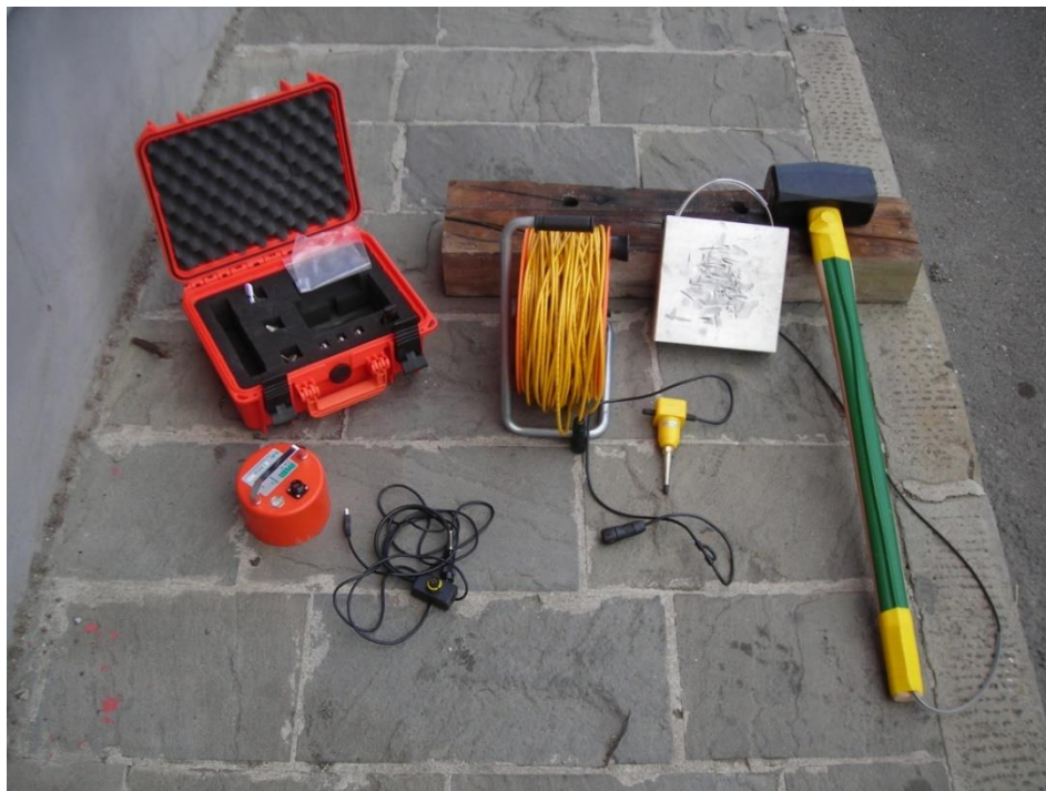
Figura A. 2b - Versione "GEMINI MASW" impiegata per la prospezione sismica attiva: lo stendimento prevede il collegamento della strumentazione procedendo da sinistra verso destra. In aggiunta va inserito il PC come per una normale acquisizione HVSR.
