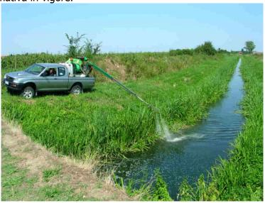
Sia i nebulizzatori che le motopompe sono corredati da una pompa autoadescante che consente il rifornimento idrico direttamente dai corsi d'acqua.
