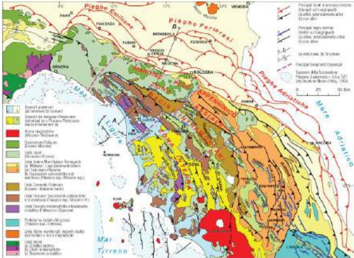
Fig. 52 Schema tettonico dell'Appennino Settentrionale e della Pianura Padana. Da Note Illustrative della Carta Sismotettonica della Regione Emilia Romagna e zone limitrofe - EDIZIONE 2017.
