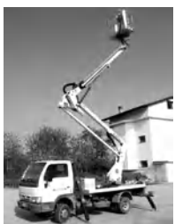
esempio di piattaforma con meccanismo di sollevamento a bracci snodabili installata su autocarro
