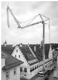
Esempio di gru idraulica installata su autocarro "leggero"
