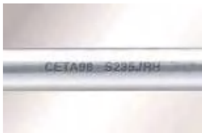
esempio di "marchio del fabbricante" su elemento di ponteggio a "tubo e giunto" (fonte CETA Spa)
