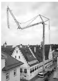
Esempio di gru idraulica installata su autocarro "leggero"
