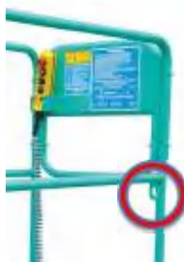
Foto 6: esempio mini PLE elettrica a pantografo e punto di aggancio previsto dal costruttore
