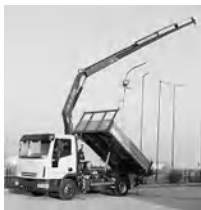
Esempio di gru idraulica installata su autocarro "leggero"
