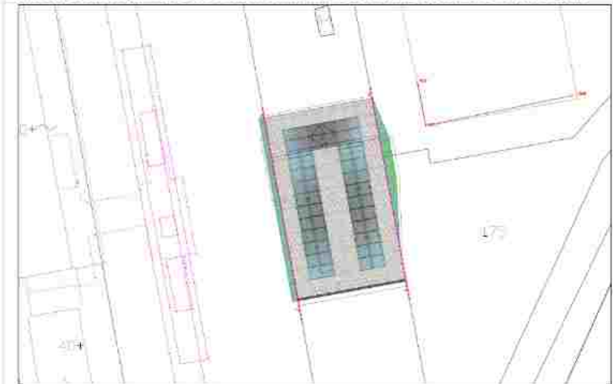
Figure 5: Visualizzazione della copertura della tettoia metallica nell'area di intervento. Con sovrapposizione (con colorazione verde) degli spazi di copertura incombenti sui mappali adiacenti (porzione di intervento Extra PNRR).
