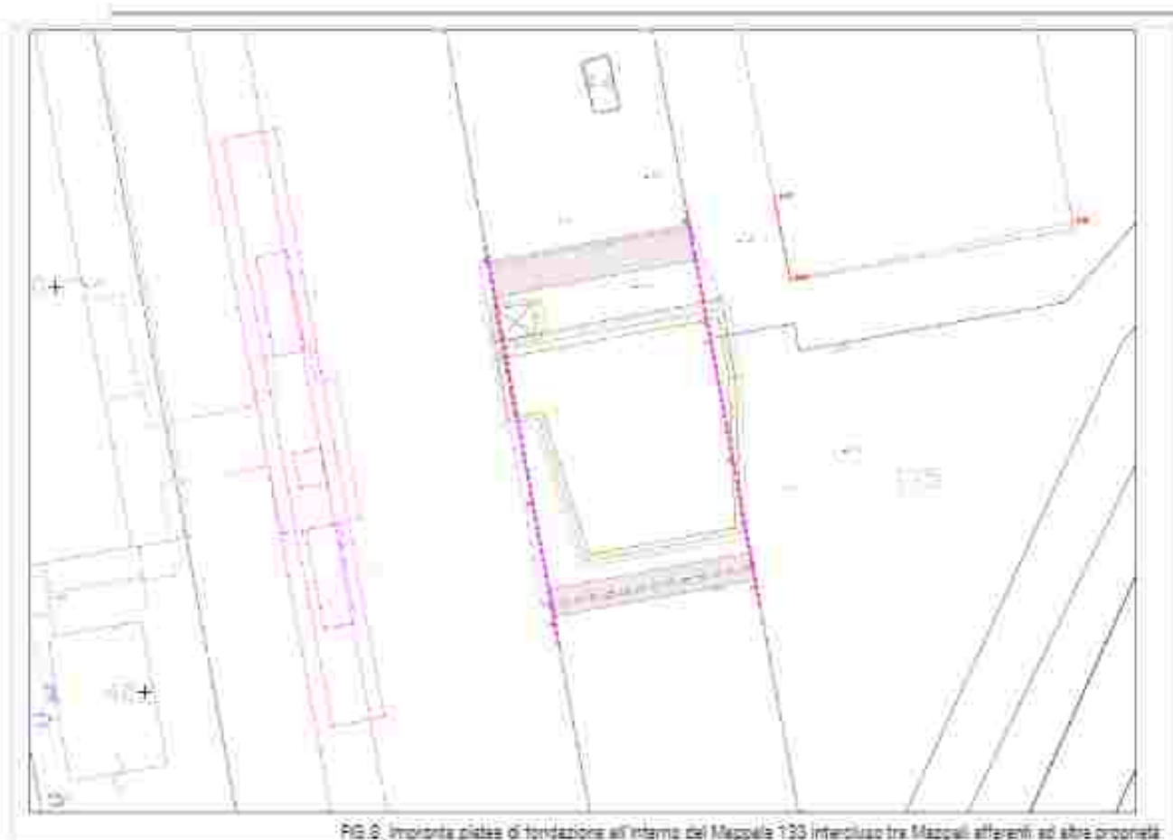
FIG. 8_ Impianti piatte di fondazione all'interno del Meppala 133 intercluso tra Meppali afferenti ad altre proprietà.
