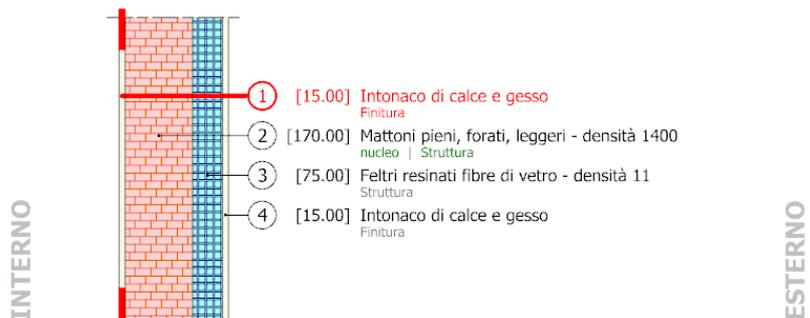
Figura 2. Schema stratigrafico dell'involucro verticale assegnato nel software
