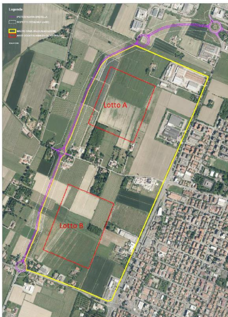
Img. 2.2.5 Stralcio Progetto di Fattibilità Tecnica ed Economica – Nuovo Ospedale di Carpi (perimetro Lotti in rosso; tracciato Bretella in viola) (scala adattata).
