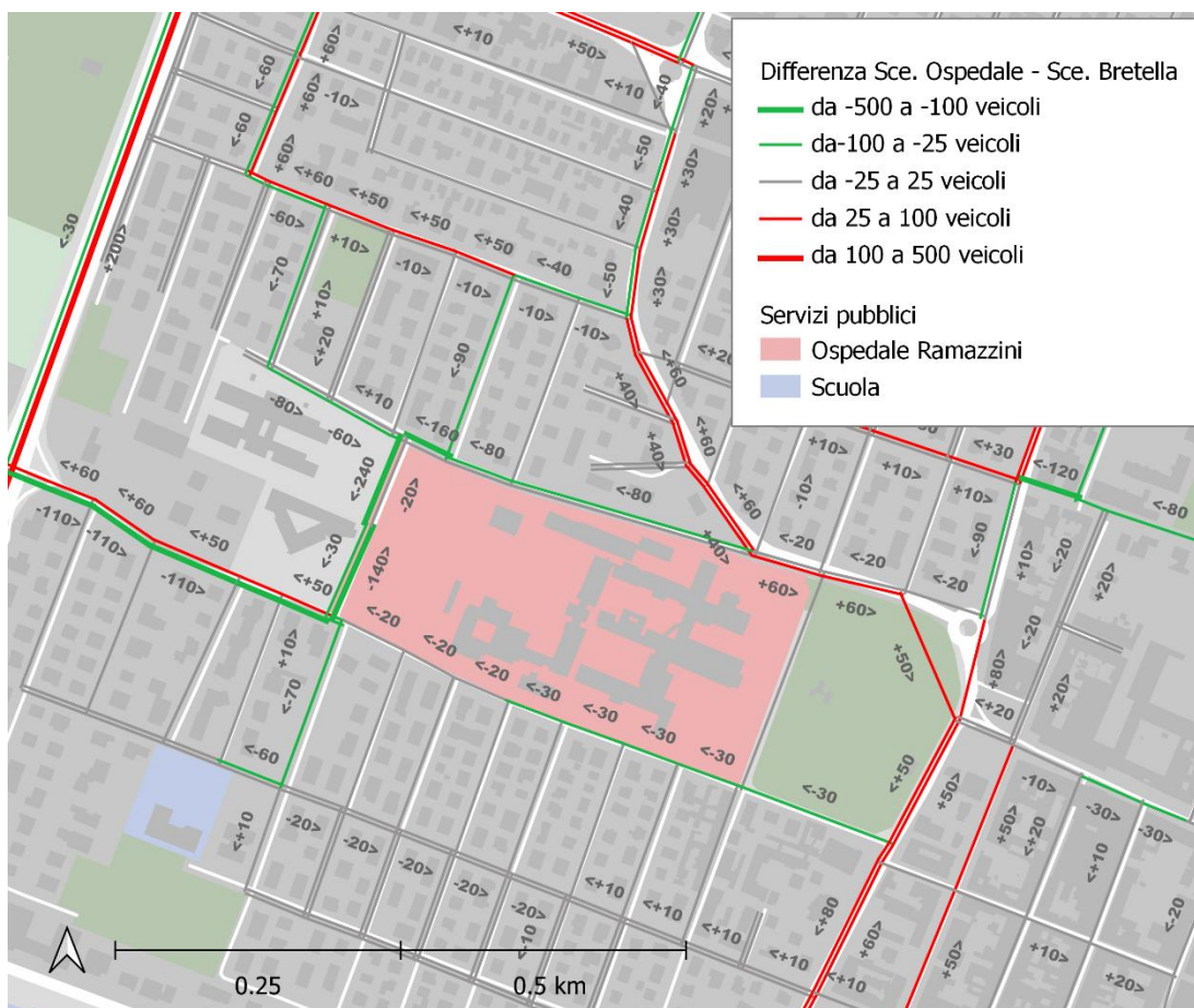
Img. 3.1.2.4 Differenza dei flussi veicolari totali tra lo scenario di progetto con il nuovo ospedale e lo scenario attuale con Bretella, zoom sull'area del Ramazzini
